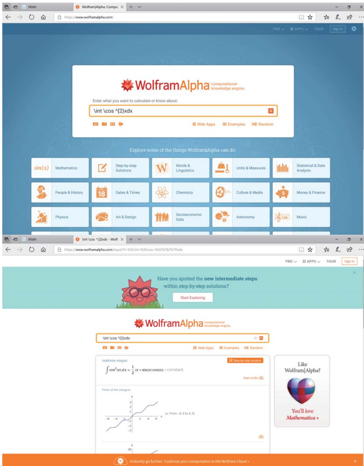
図6 Wolfram|Alphaの活用例：図5で手書き入力した不定積分のLaTeXコマンドをコピーし、Wolfram|Alphaの検索ボックスにペーストし実行すればその解が表示される。ただし、複雑な計算式のLaTeXコマンドになれば、その計算式が認識されないことも多い。
